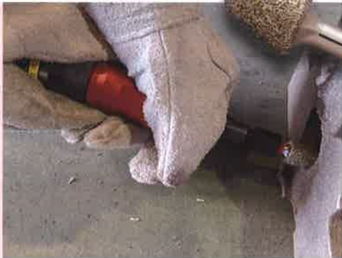
鋳物のバリ取り
